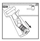
2. Inserta el extremo macho XLR en la base del mango de la forma mostrada, con el extremo sobresaliendo ligeramente.
