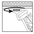
Para resituar el mango, en primer lugar deberás girar varias veces el dial de bloqueo del mango hacia la izquierda para aflojarlo.
