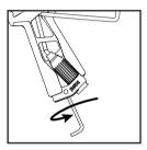
2. Con una llave Allen de 3mm, desenrosca la abrazadera XLR/adaptador de rosca y retíralo del conjunto del mango.
