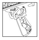
3. Cierra la abrazadera inclinada en el lado izquierdo del mango para bloquearlo en su posición.
