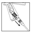
1. Para retirar el cable profesional preinstalado del Blimp, desconecta primero todos los cables conectados.
